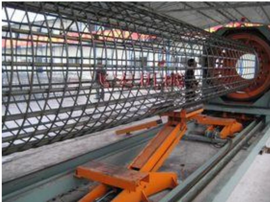
钢筋笼数控滚焊技术应用
