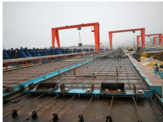
预应力带肋混凝土叠合板生产线图
